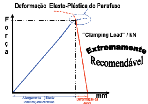
Figura 4 – Diagrama mostrando a condição mais recomendável, quando se quer obter a máxima Força do Elemento de Fixação
