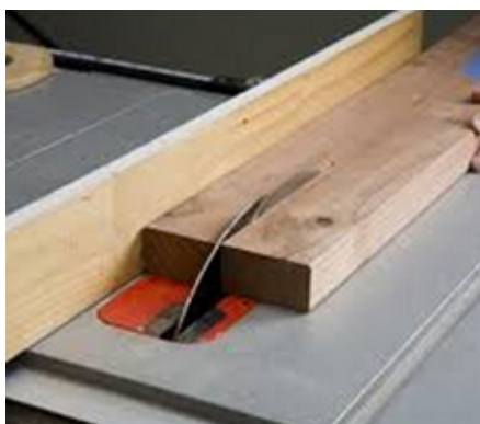
Figura 140 - Perigo de Contato com o Disco de Serra devido a falta de proteção adequada
