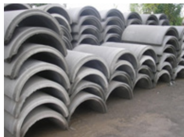
Figura 79 - Armazenamento de Canaletas de Concreto
