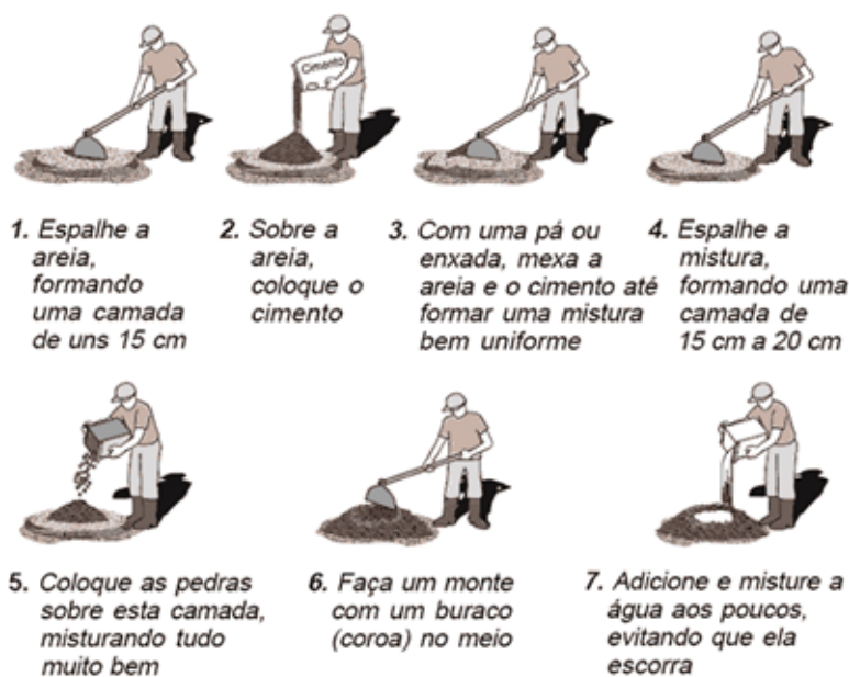
Figura 186 - Preparo Manual de Concreto
