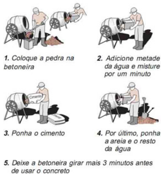
Figura 187 - Preparo do Concreto e m Betoneira
