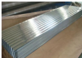
Figura 74 - Armazenamento de Telhas Metálicas
