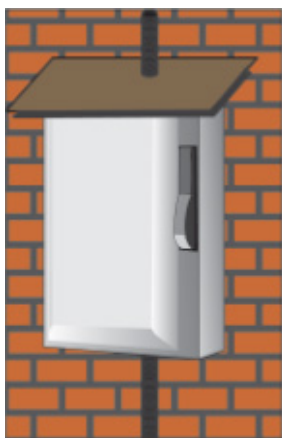
Figura 219 - Quadros Intermediários (Divisórios)
