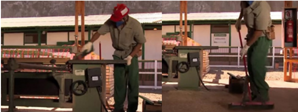
Figura 146 - Limpeza da Máquina de Serra
