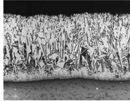
Figura 31: Microestrutura de camada espessa, obtida sobre um aço rico em silício.
