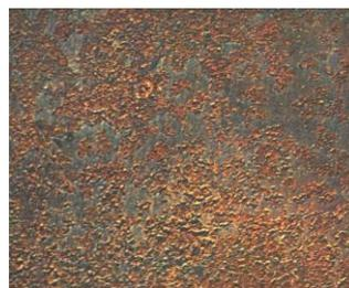
**Grau C** – superfície de aço onde toda a carepa de laminação foi eliminada e na qual se observa uma corrosão atmosférica uniforme generalizada, sem, contudo, apresentar sinais de formação de cavidades visíveis. Chapa ou perfil que sofreu um completo intemperismo desagregando toda a carepa de laminação podendo o restante ser removido por raspagem.
