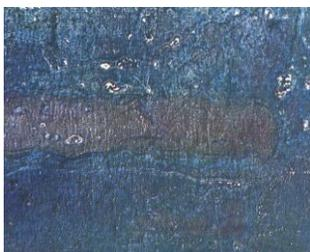
**Grau B** – superfície de aço com princípio de desprendimento de carepa de laminação devido à corrosão atmosférica e dilatação diferencial carepa-metal. Chapa ou perfil com início de oxidação e da qual a carepa começou a se desprender ou que sofreu pequena ação
