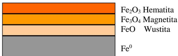
**Grau A** – superfície de aço com a carepa de laminação aderente intacta, com pouca ou nenhuma oxidação ao longo de sua superfície. Chapa ou perfil, em geral, recém-saído da laminação.
