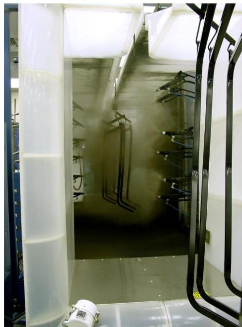
Equipamento de aplicação automática de tinta em pó
