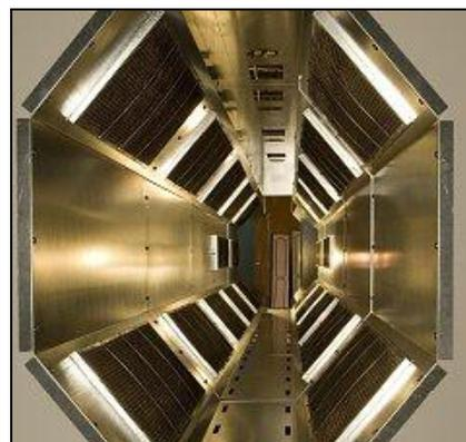
Estufa de cura contínua por radiação infravermelho
