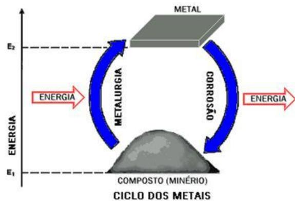
As reações de corrosão são espontâneas. Enquanto na metalurgia adiciona-se energia ao processo para a obtenção do metal, na corrosão observa a volta espontânea do metal à forma combinada, com conseqüente liberação de energia. Este ciclo é denominado de “ciclo dos metais”.
