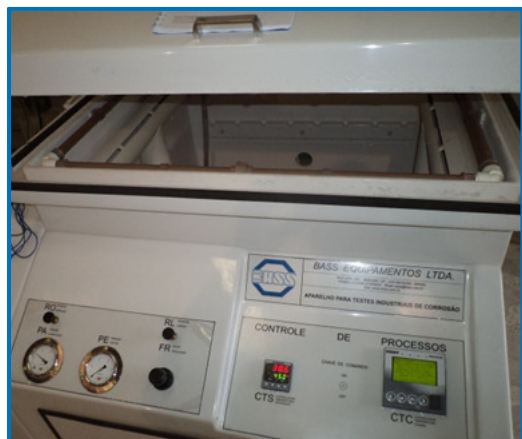
Imagem 4: Esquema de câmara de corrosão BASS-CCT
