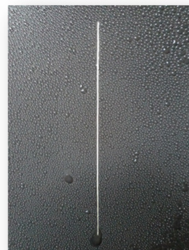
Imagem 7: Peça durante ensaio de umidade saturada.
