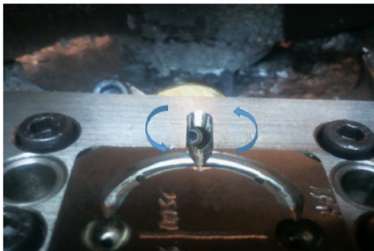
Imagem 7 - Afinação do molde em relação ao molde.
