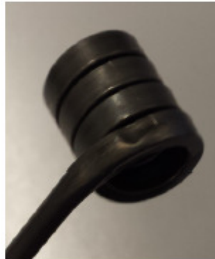
Imagem 13 - Dano na resistência durante a montagem
