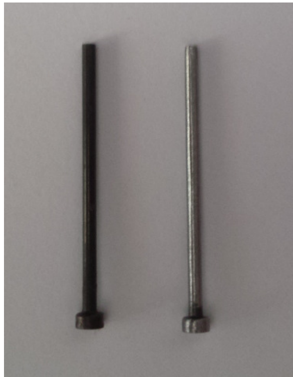
Figura 157 - Extratores com revestimento e sem revestimento.
