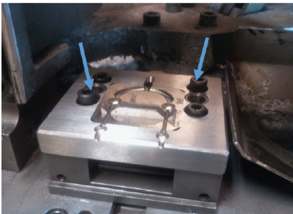
Imagem 2 - Fixação do molde á estrutura.
