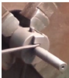
Imagem 6 - Posicionamento da resistência na ferramenta de dobrar
