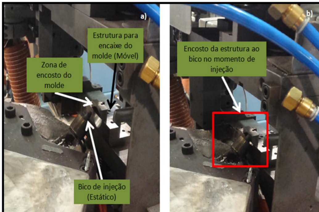
Figura 67 - a) Molde recuado; b) Contacto do molde com bico de injeção.
