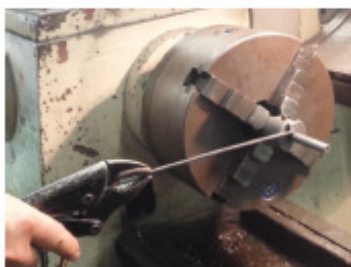
Imagem 7 - Posicionamento do alicate de pressão para auxiliar a dobragem da resistência
