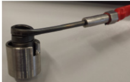
Imagem 12 - Posicionamento da resistência na cápsula de proteção
