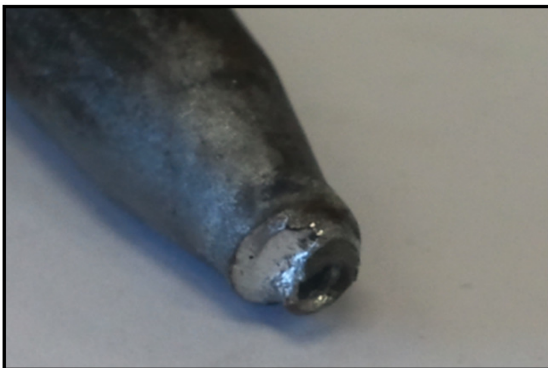
Figura 130 - Desgaste da ponta do bico injeção.
