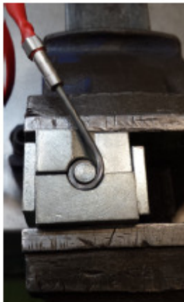
Imagem 10 - Aperto da resistência na ferramenta com o auxílio do torno
