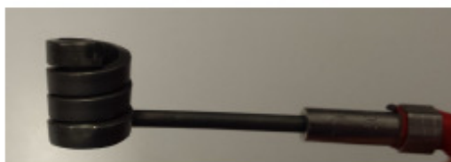
Imagem 11 - Aspeto da resistência após dobragem e aperto
