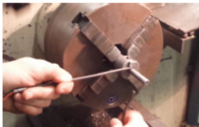
Imagem 4 - Aperto da resistência á ferramenta de dobrar
