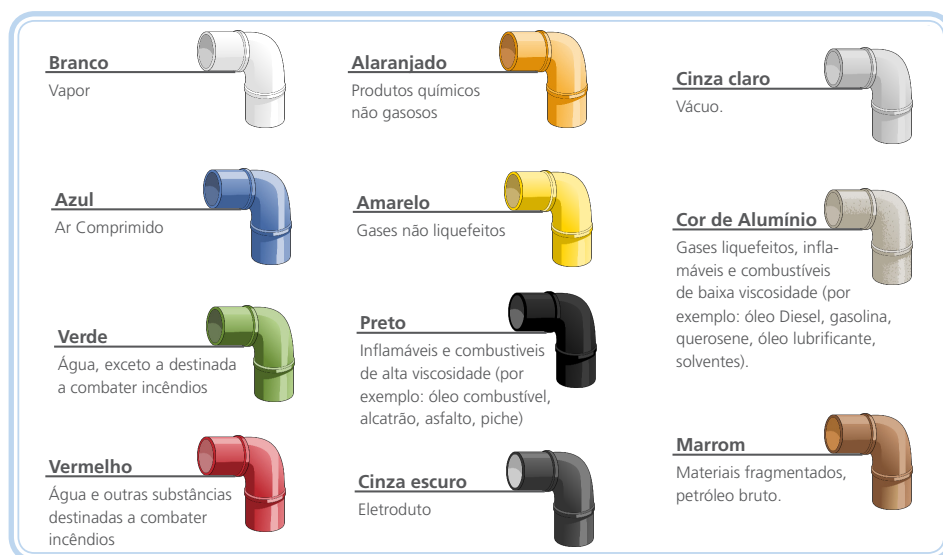
Figura 17.1: Emprego de cores em tubulações.
