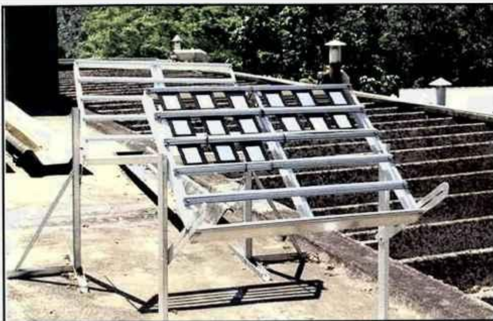
Figura 4.1 – Corpos-de-prova dos sistemas de revestimento expostos ao intemperismo climático.
