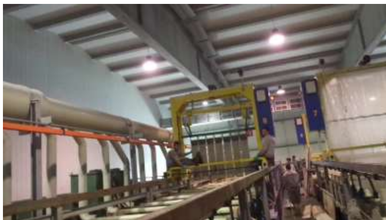
Figura 22 – Utilização dos bastidores para transporte de ânodos de cobre
