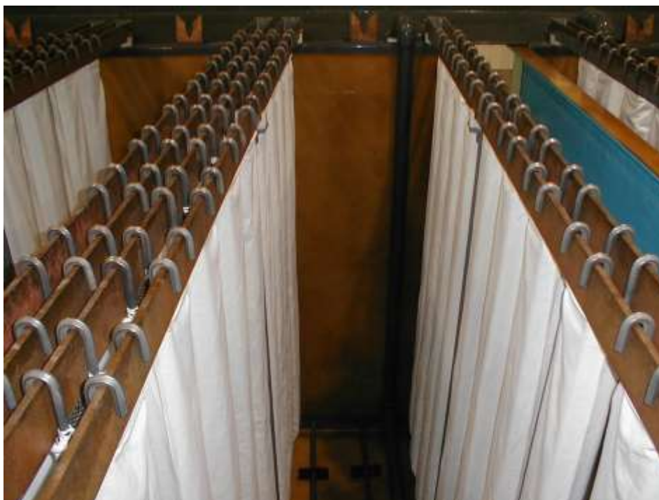
Figura 19 –Ânodos de Cobre em sacos de polipropileno para evitar perdas de metal ou impurezas para o banho
